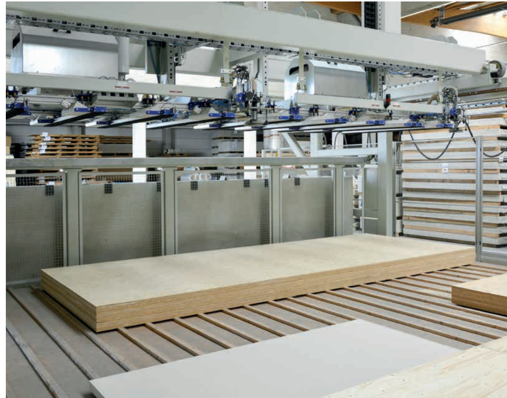
Beschickungsportal mit Rohplattenlager.
