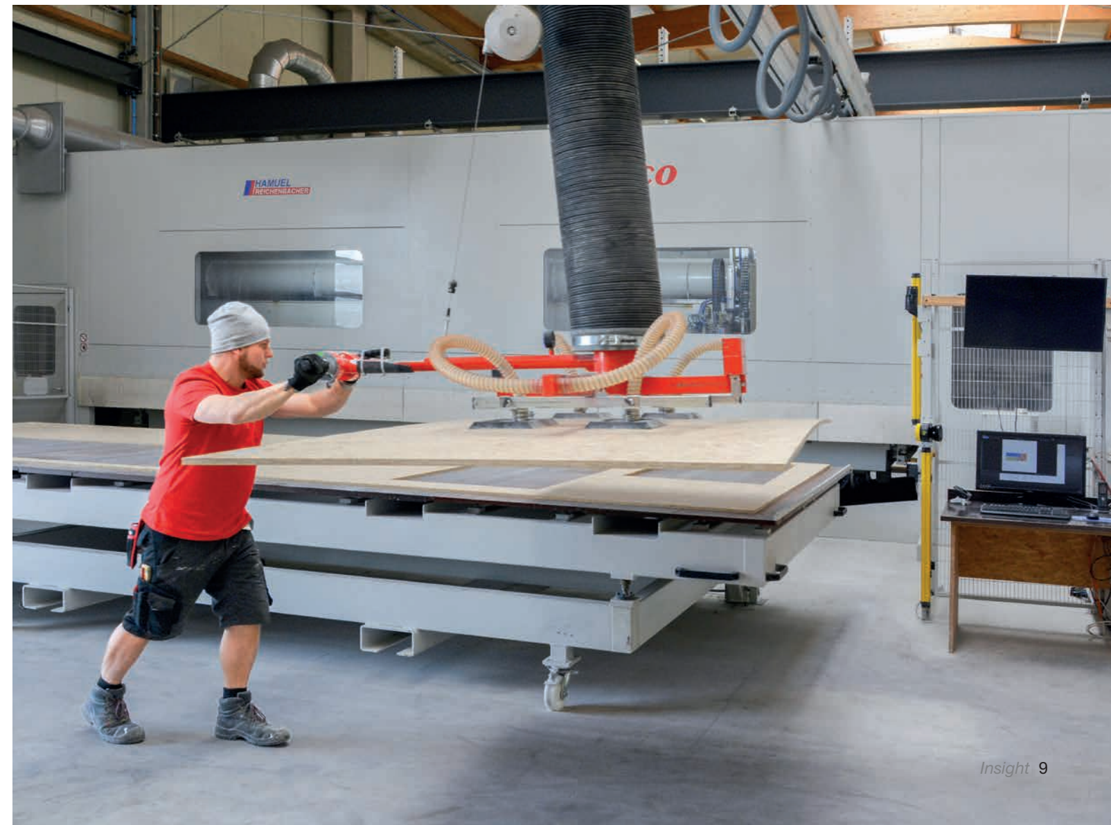
Der Bediener kann genestete Platten auf dem Entnahmetisch abheben.
