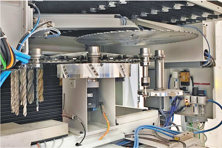
► In der Produktion bei Setra: CNC-Bearbeitungszentrum Vision III-TT, auf der die Bearbeitung und Vorfertigung großer CLT-Platten für Häuserwände, Decken- und Dachelemente stattfindet. Die Anlage ist ausgestattet mit automatischem Tellerwechsler für 30 Werkzeuge.
