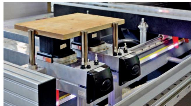
Der Konsolentisch mit 6.400 mm Länge ist mit acht Trägern mit je zwei Pneumatik-Vakuuman-schlüssen ausgestattet. Die Träger lassen sich manuell verstellen.
