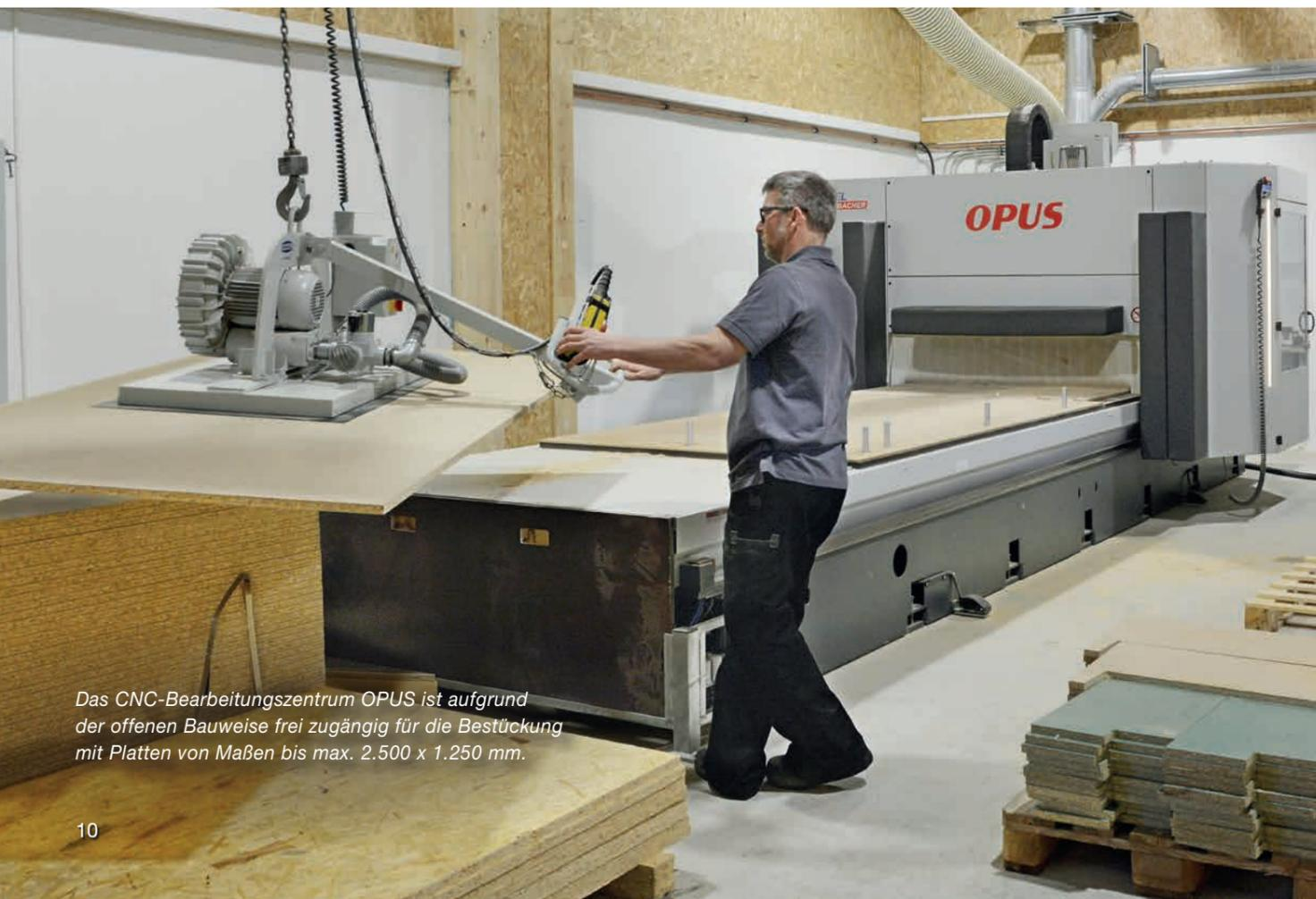
Das CNC-Bearbeitungszentrum OPUS ist aufgrund der offenen Bauweise frei zugänglich für die Bestückung mit Platten von Maßen bis max. 2.500 x 1.250 mm.
