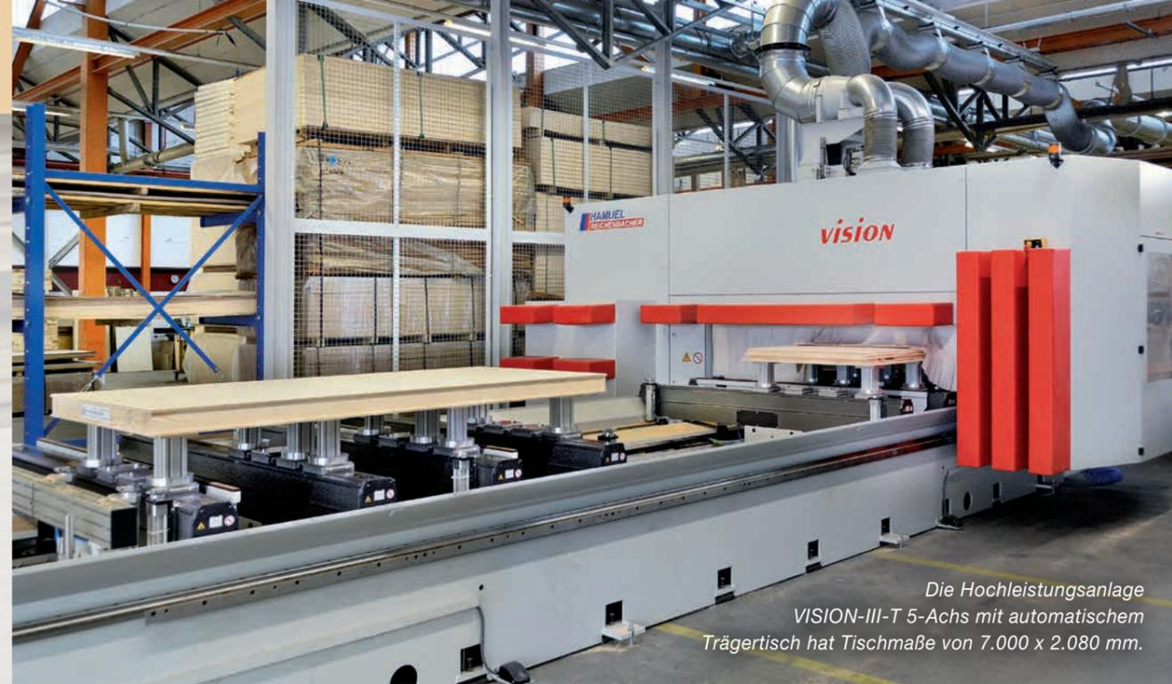
Die Hochleistungsanlage VISION-III-T 5-Achs mit automatischem Trägertisch hat Tischmaße von 7.000 x 2.080 mm.
