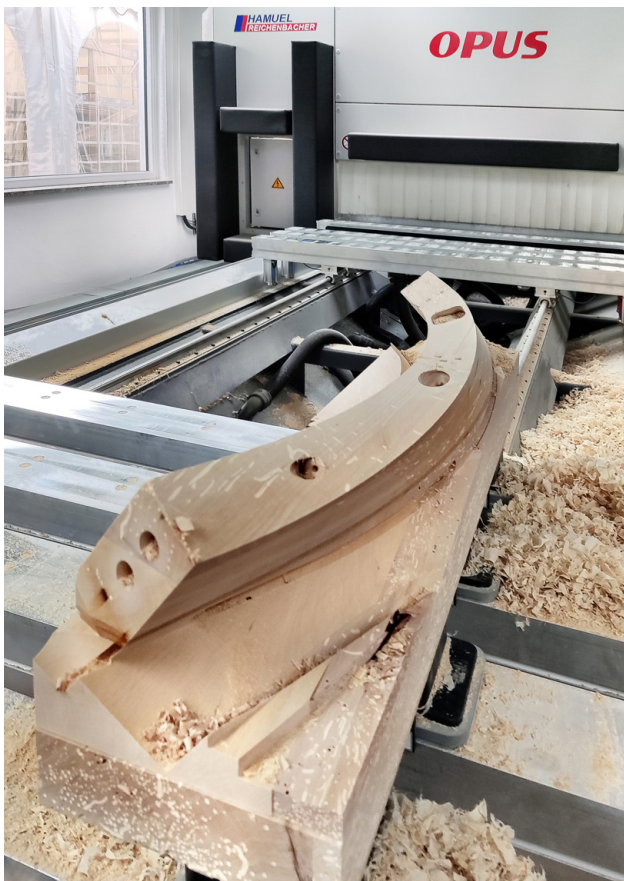
► Sauger werden exakt auf den Traversen platziert.
