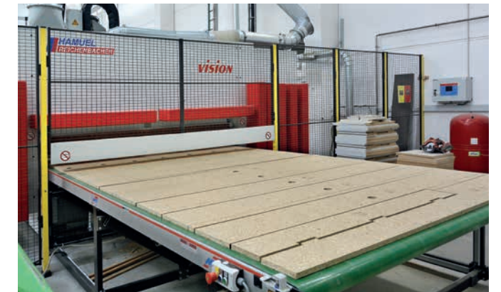
Abnahmetisch mit Transportband für Bauteile und Reststücke.
