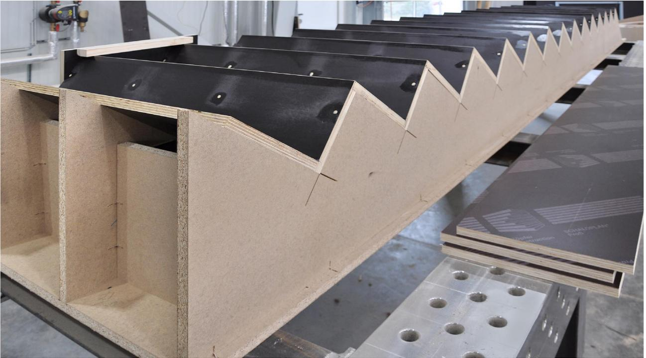
► Für die Fertigung der Negativschalungen setzt Innbau-Beton Spanplatten, beschichtete Spanplatten und Mehrschichtplatten ein.
