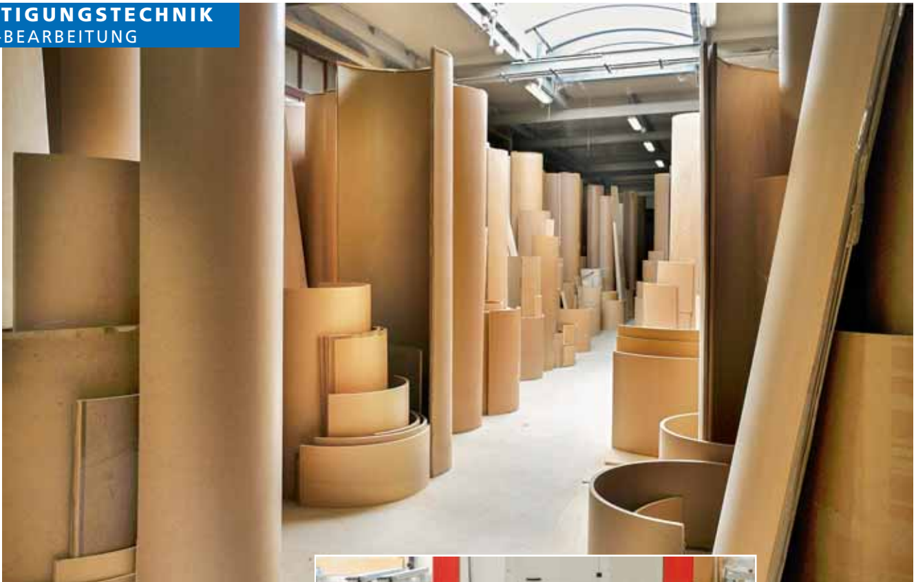
Im Lager befinden sich diverse Rund-Bauteile, die auf der Fünf-Achs-Anlage bearbeitet werden
