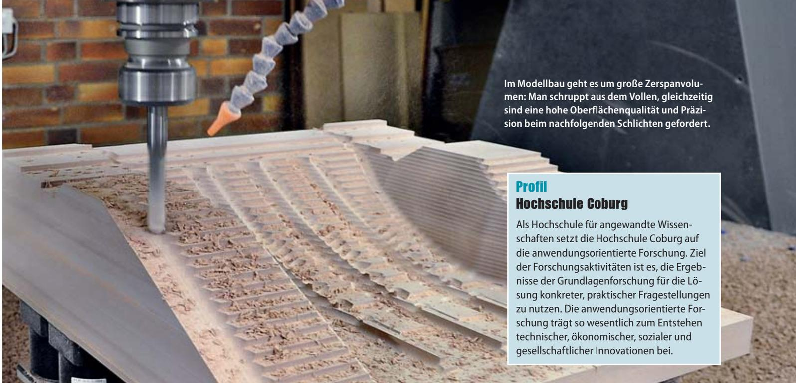
Im Modellbau geht es um große Zerspanvolumen: Man schruppt aus dem Vollen, gleichzeitig sind eine hohe Oberflächenqualität und Präzision beim nachfolgenden Schlichten gefordert.
