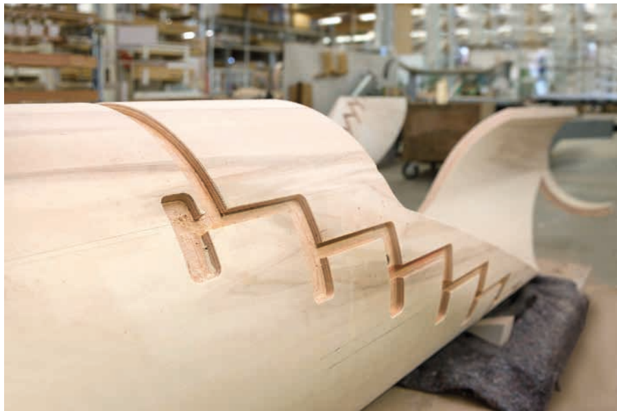
▼ Spezialität des Hauses: Große Krümmlinge lassen sich aufgrund der hohen Z-Achse von 700 mm auf der Reichenbacher problemlos bearbeiten (Bilder: Meyer & Grave Tischlerei)
