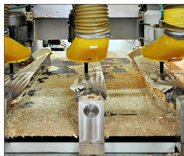
После грубого фрезерования следует чистовое фрезерование, занимающее около 25 минут на каждую сторону для небольшой лопасти пропеллера
