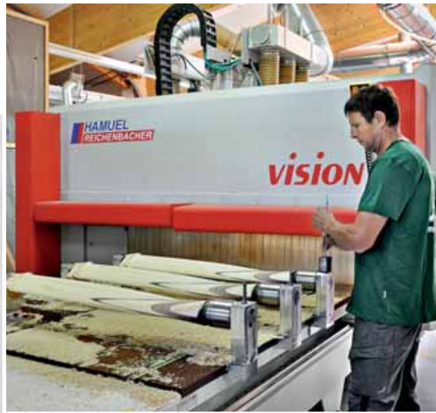
Oben: Alois Kermer an einem Bearbeitungszentrum des Typs „Vision Inline“. Die Blätter werden für das Fräsen der Blattunterseite in speziellen Aufnahmen gedreht. Rechts: Beim Schleifen ist nach wie vor Handarbeit gefragt
