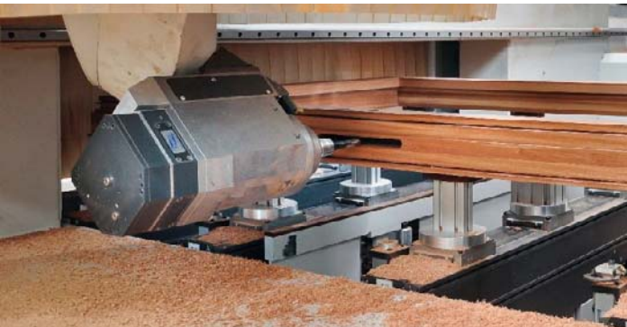
/ Beispielsweise für horizontal gefräste Schlösser ist das 5-Achs-Aggregat das ideale Werkzeug, denn ein separates Schlosskastenaggregat ist nicht erforderlich.
