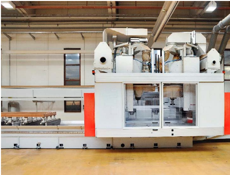
/ Das Doppelportal ist mit einem 5- sowie einem 4-Achs-Aggregat bestückt und hochflexibel für Einzelfertigung ausgelegt. Das Bearbeitungszentrum kann Teile bis zu einer Größe von 6140 x 2170 mm bearbeiten.
