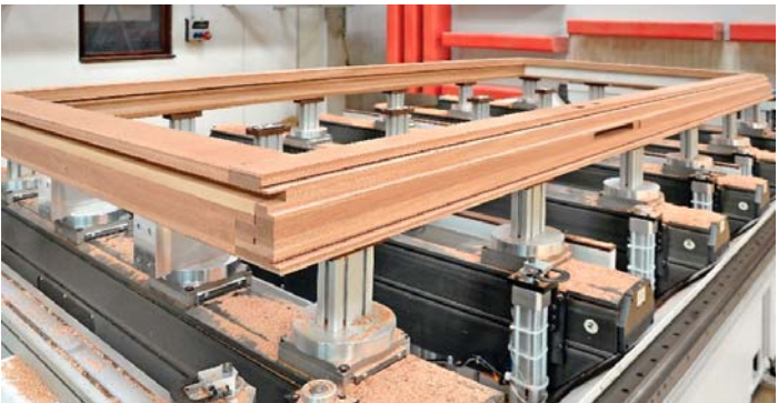
/ Der vollautomatische Trägertisch ist überaus umfangreich für alle denkbaren Komplettbearbeitungen bestückt. Auch Pfostenspanner sind an Bord.
