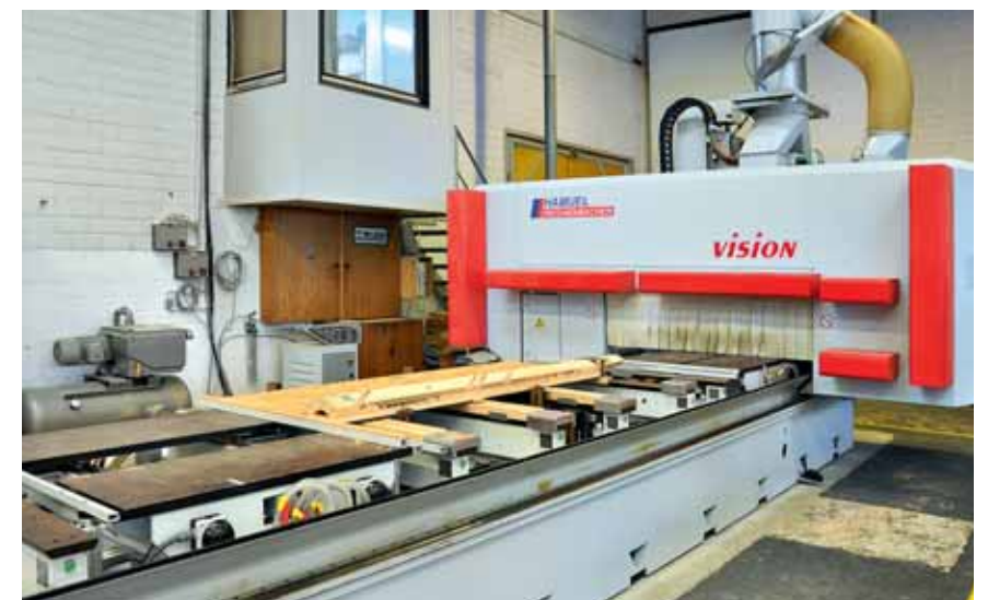
CNC-Bearbeitungszentrum „Vision-II-ST Sprint“ mit aufgespanntem Standardkrümmung
