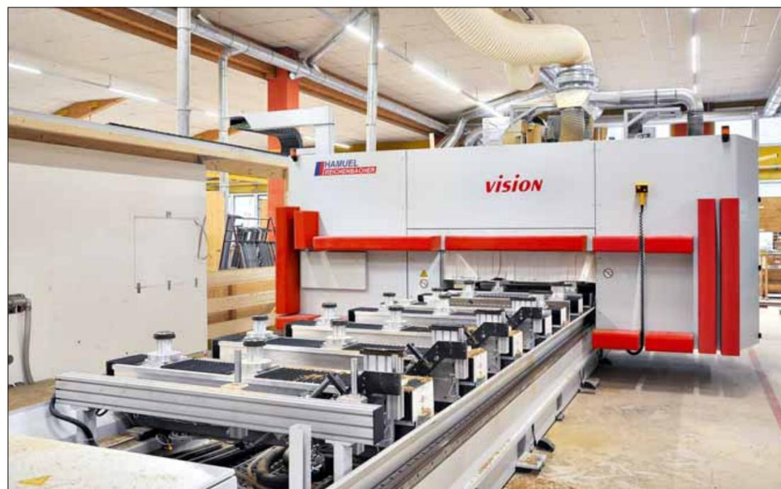
Большой станок модели „Vision II Sprint“ оснащен автоматическим несущим столом и цепным магазином для инструмента на 40 мест.
