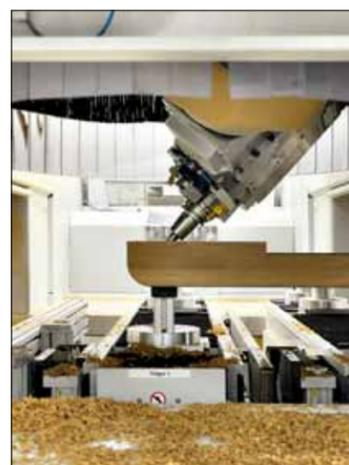
Пяти-осевой агрегат при обработке дерева
