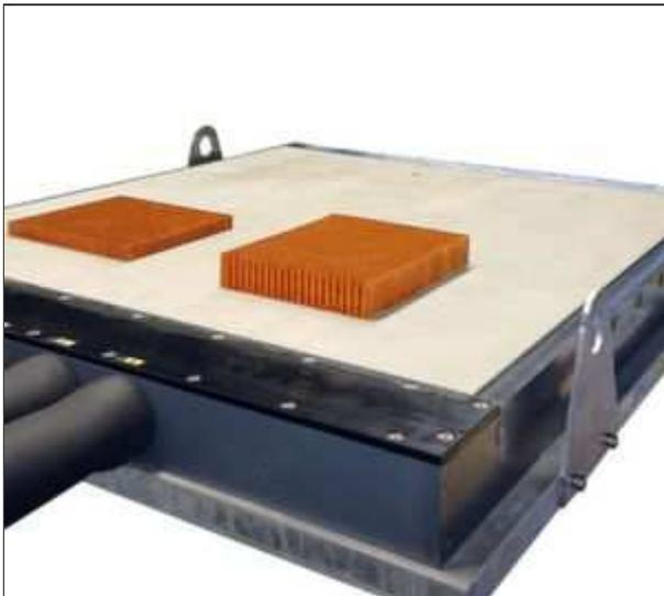
Empfindliche, oder poröse Werkstücke, wie diese Wabenkerne für Leichtbau-Anwendungen, können mit Eis fixiert, und somit präzise mechanisch bearbeitet werden. Reichenbacher Hamuel hat die Technik im Lieferprogramm. (Bild: Reichenbacher Hamuel)
