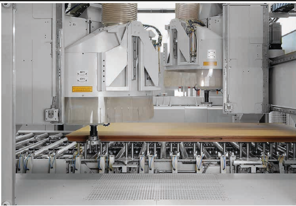
▲ Herzstück des Bearbeitungszentrums Vision-U mit Pin-Tisch und zwei 5-Achs-Aggregaten (Fotos: Prüm Türenwerk, Reichenbacher Hamuel)
