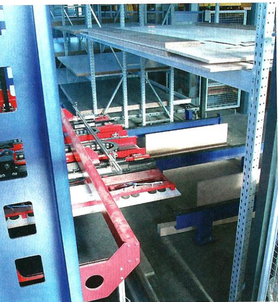
▲ Saugrahmen zum Vereinzeln der Plattenmaterialien
