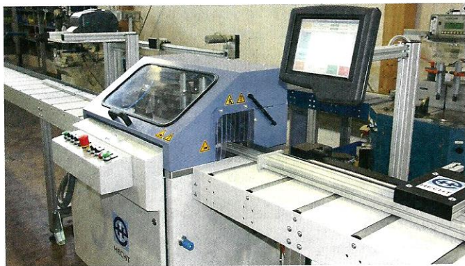
◀ Die Sägeanlage lässt sich komfortabel und intuitiv über einen Touchscreen-Monitor bedienen
